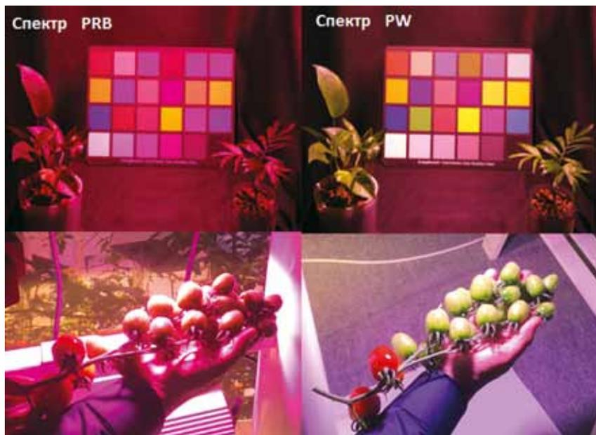
Рис. 6. Цветопередача светодиодов PRB и PW
